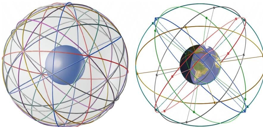
Fig. 4: Verteilung von GPS-Satelliten (links: theoretisch, rechts: praktisch)
