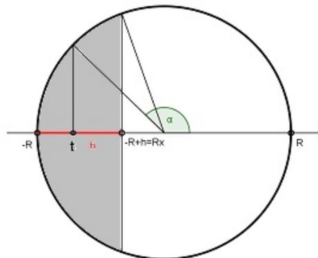
Das Heizöl im Tank füllt geometrisch ein Prisma mit der Seitenlänge  $L$  und einem Kreissegment als Grundfläche; der Radius des Kreissegmentes ist  $R$ , seine Höhe ist  $h$ . Der Öl-Inhalt ist das Volumen
