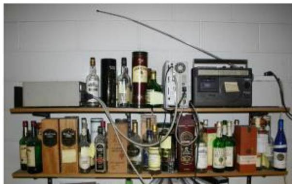
**Abbildung 23: Früher Aufbau des Zufallszahlengenerators der Website RANDOM.org. Zu sehen sind das Radio, als Empfänger der Wellen, links davon ein Sun SPARCstation-Arbeitsplatzrechner mit dem Betriebssystem Solaris und ganz links im Bild eine 500 MB-Festplatte zum Speichern der erzeugten Bits.**
