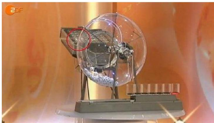
**Abbildung 27:** Eine sogenannte Trommel für die Lottozahlenziehung. Dahinter ist der Schlitten, mit der Stelle an der die Kugeln hängenblieben (rot) zu sehen
