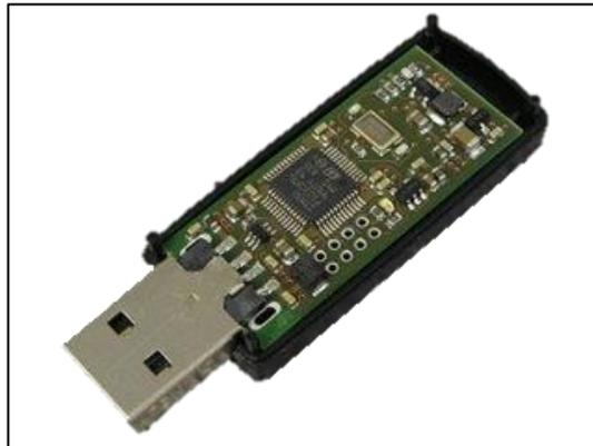
Abbildung 21: Mögliche Schaltung für einen On-chip Zufallszahlengenerator (hier als USB-Stick realisiert)
